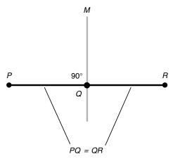
Fig. 4-6. Perpendicular-bisector principle.
