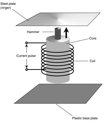
Fig. 14-6. A bell ringer using a solenoid.
